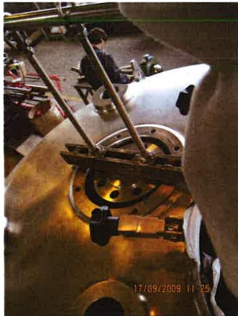
8. Die Sicherungsscheibe (Pos. a11) lösen (Rechtsgewinde) und das Mischerblech (Pos. a5), das durch die Bolzen (Pos. a8) und den Sicherungsring (Pos. a9) gesichert ist, demontieren.
