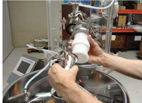
*Fig. 10 Einfügen des Verbindungsrohres/Schlauchs*
