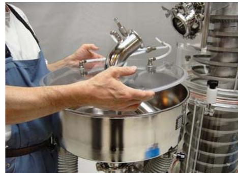
Fig. 8 Aufsetzen des Deckels mit Einlauf
