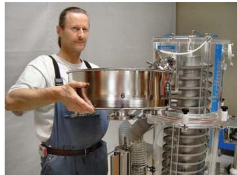
Fig. 5 Aufsetzen des Verteilers auf dem Motorflansch
