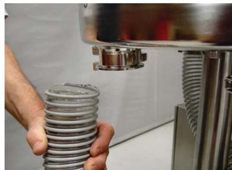
*Fig. 12 Aufstecken der Gebindeschläuche*
