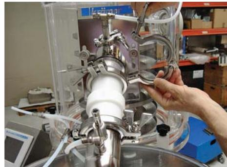
*Fig. 11 Anbringen der Triclampverschlüsse*
