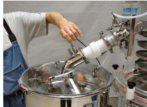
Fig. 13 Verbinden des Sensorsteckers
