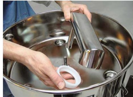
Fig. 7 Einsetzen des Verteilerrohres mit dem Verteilerring
