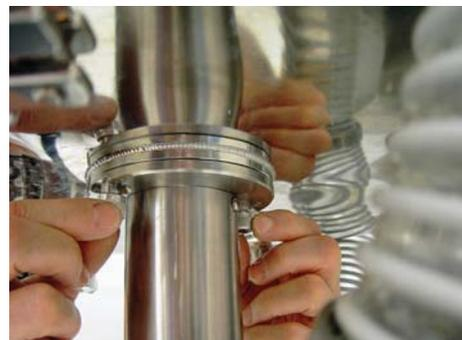
Fig. 6 Festschrauben des Verteilertopfes
