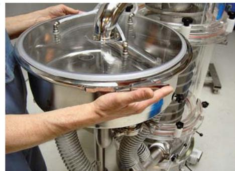
Fig. 9 Anziehen des Spannrings
